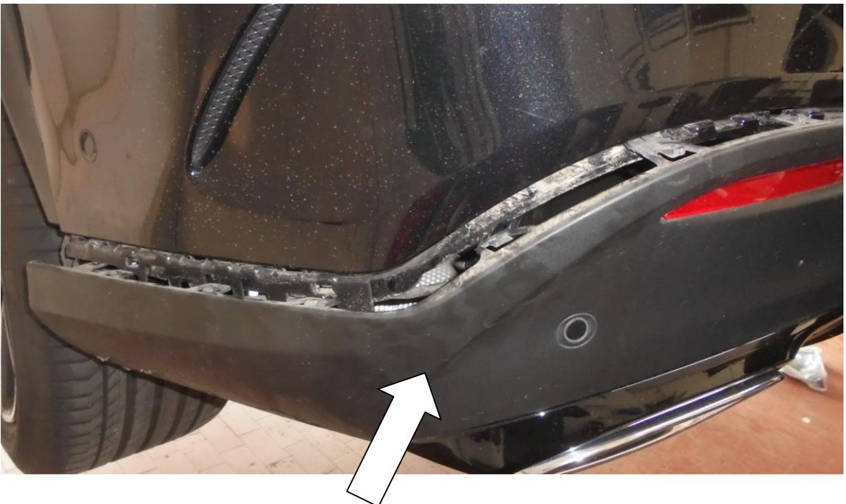
3. Die Rastnasen der Heckverkleidung können durch Unterstützung von innen / hinten oder von vorne mittels geeigneten Werkzeug leicht nach unten gedrückt werden, was die Demontage deutlich erleichtert.
