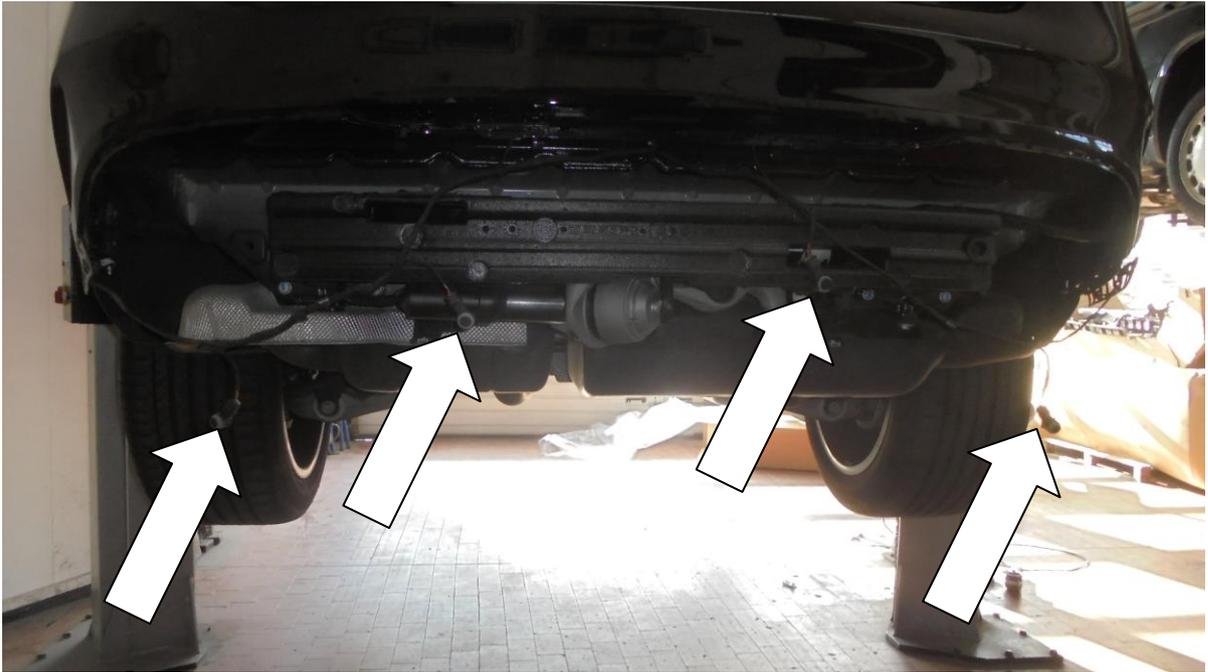
5. Die Leitung bei Fahrzeugen mit AHK sollten bewegungssicher an der Rückwand fixiert werden. Seiten des Herstellers ist diese nicht bewegungssicher verbaut und liegt einfach nur so am Träger verlegt.
