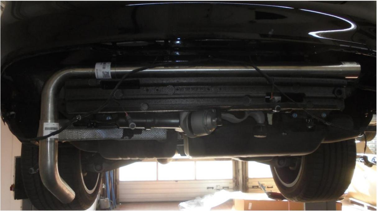
7. Die Leitungen der PTS Sensoren sollten an der Oberkante der Heckstoßstange im Bereich der Aufnahme für die Heckblende neu verlegt bzw. befestigt werden.
