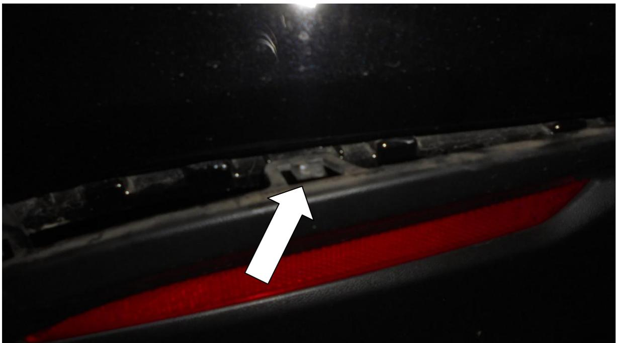
4. Es wird empfohlen die PTS Sensoren aus der Halterung zu demontieren, nicht durch Trennung der Steckverbindung.
