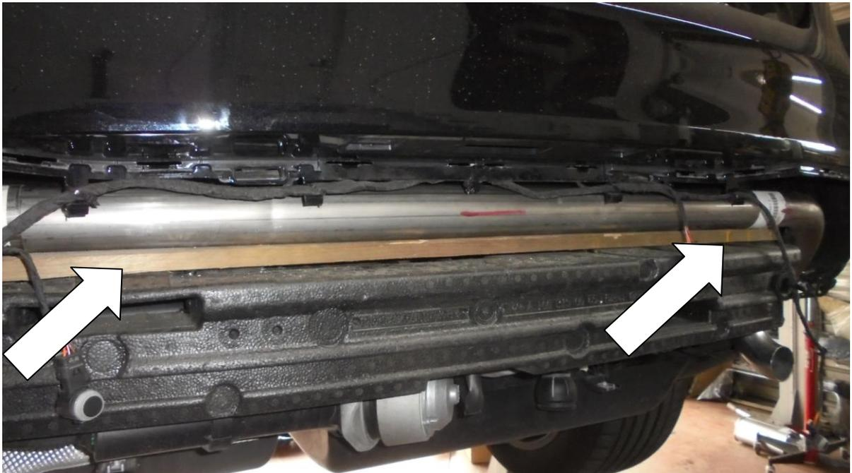
10. Abgasverteilungsrohr zusammensetzen für Anschluss des hinteren Abgasausgangsrohr des Serienschalldämpfers.
