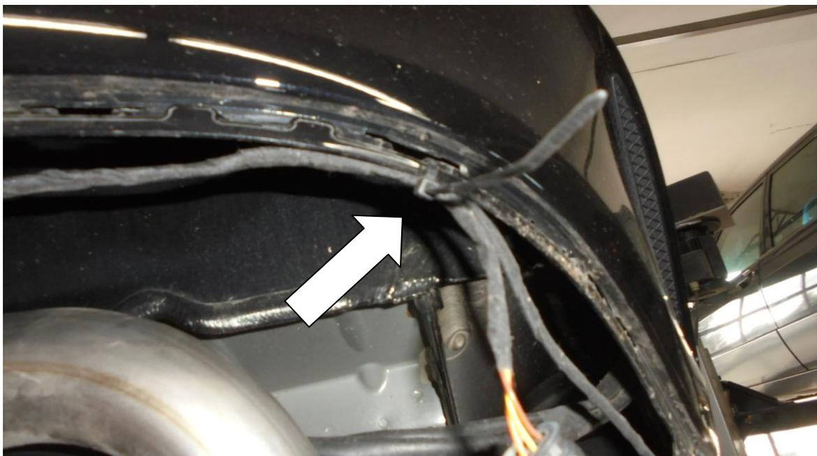
9. Für die Ausrichtung wird empfohlen ein ca. 1,5 cm breiter Abstand zum Querträger herzustellen.
